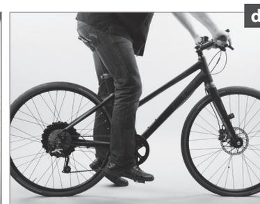
7. Sind Sattel und Lenker richtig eingestellt? Der Sattel sollte so eingestellt sein, dass Sie das Pedal in unterster Stellung mit der Ferse gerade noch erreichen können. Prüfen Sie, ob Sie den Boden noch mit den Fußspitzen erreichen können, wenn Sie im Sattel sitzen (d). Der CUBE Fachhändler hilft Ihnen, wenn Sie mit Ihrer Sitzposition nicht zurechtkommen. Weitere Informationen finden Sie im Kapitel „**Fahrrad einstellen und bedienen**“ in Ihrer allgemeinen CUBE-Bedienungsanleitung.
